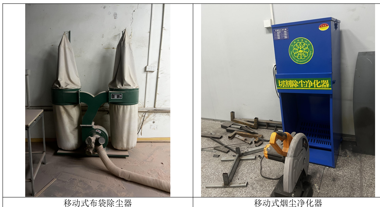
图 4.1-7 无组织废气治理设施现场照片
